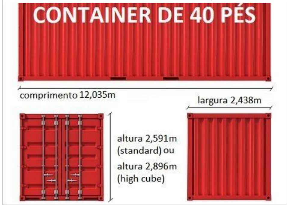
Figura 3 - Medidas do container de 40 pés
