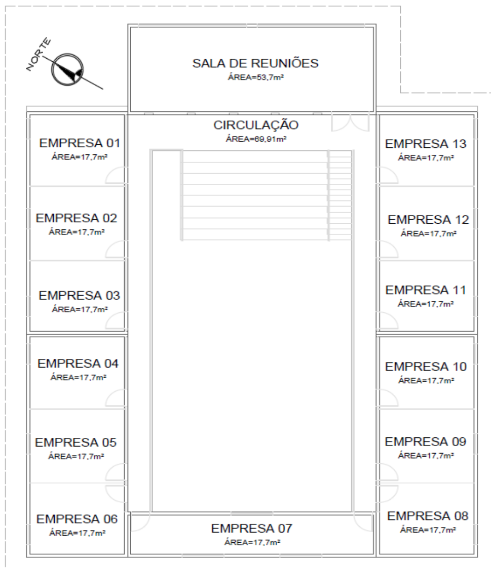
Figura 10 - Planta baixa final: pavimento superior
