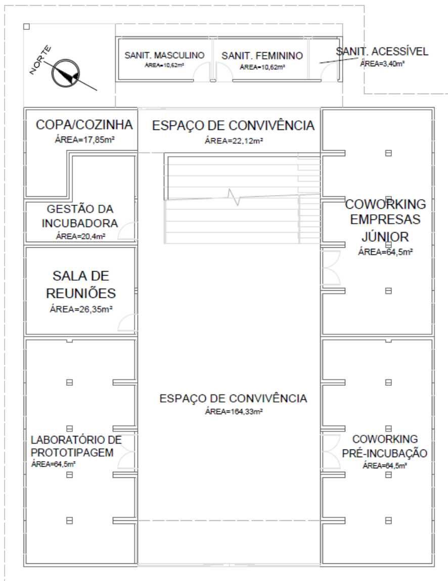
Figura 9 - Planta baixa final: pavimento térreo
