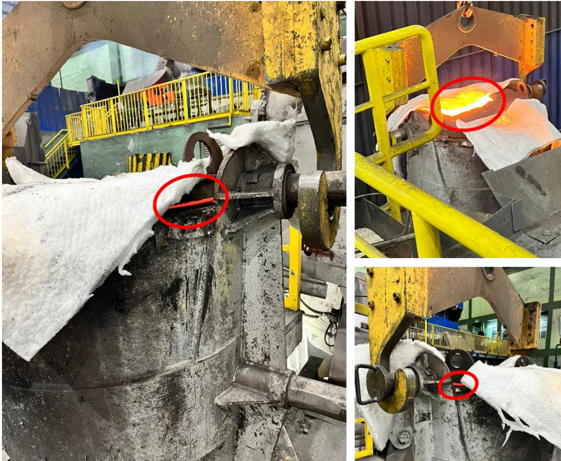
Figura 39 - Fugas térmicas da panela durante a validação de dados.
