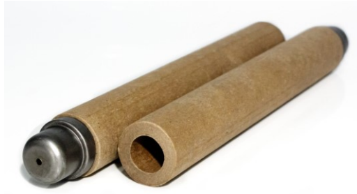
Figura 19 - Termopar tipo S com tubo de proteção de papelão.
