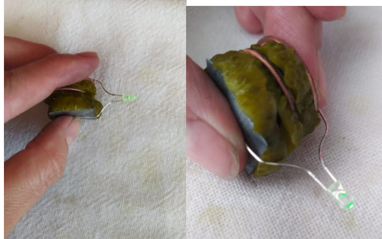
Figura 17 – Pilha usando zinco e alimento em funcionamento
