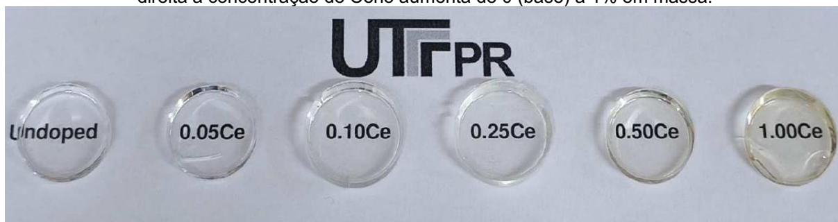
Figura 17- Fotografia dos monólitos xerogéis sintetizados para este trabalho. Da esquerda para a direita a concentração de Cério aumenta de 0 (base) a 1% em massa.
