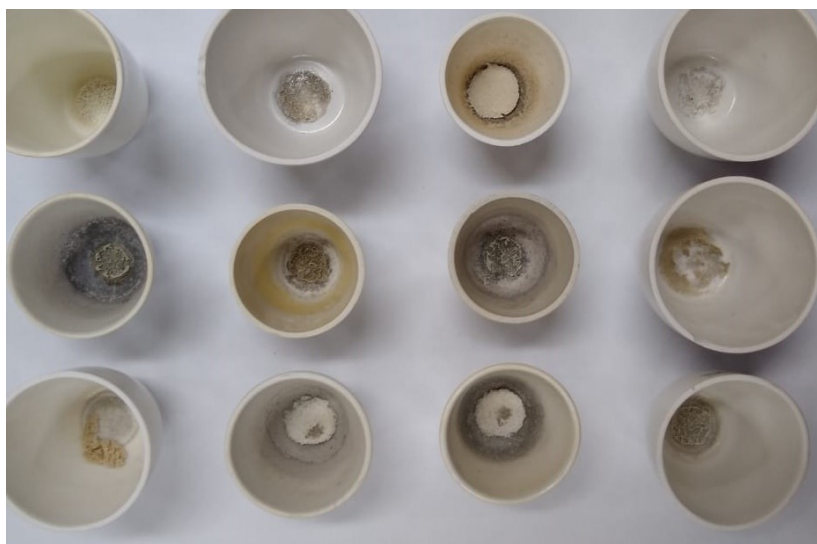
Figura 10 – Cadinhos com amostra de cinzas após sair da MUFLA
