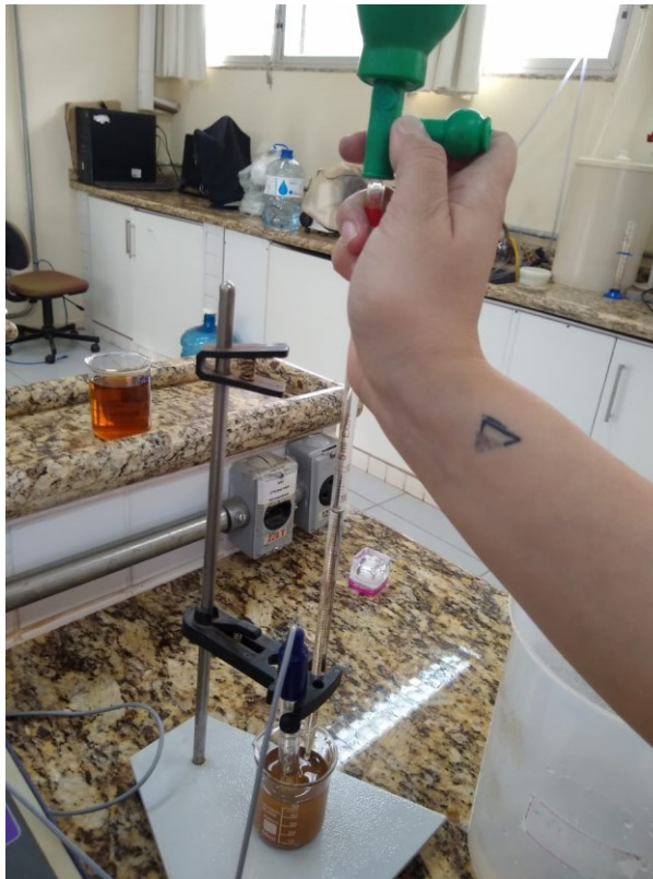
Figura 6 – Adição de solução de NaOH até atingir pH 7
