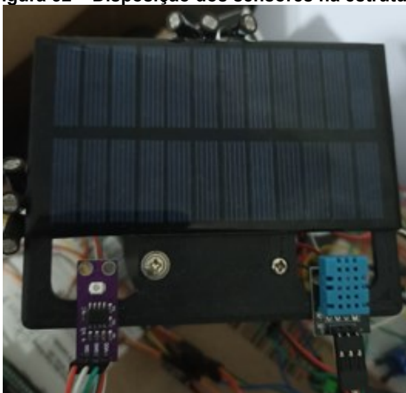
Figura 32 – Disposição dos sensores na estrutura
