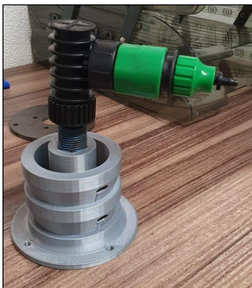
Figura 19 – Conjunto transferidor de água e energia
