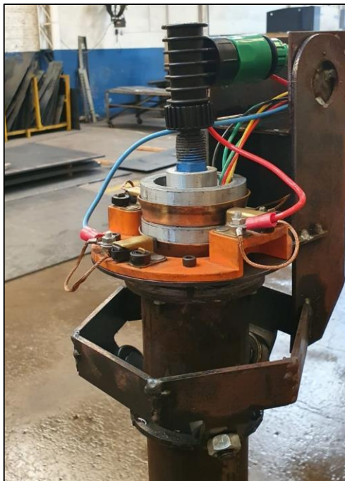
Figura 34 – Anel coletor montado.
