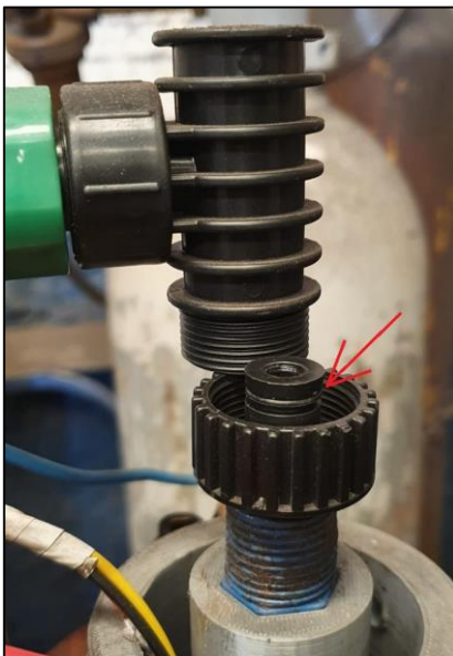
Figura 17 – Posição anel O'Ring
