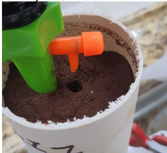
Figura 13 – Gotejador acionado sobre a coluna de adsorção
