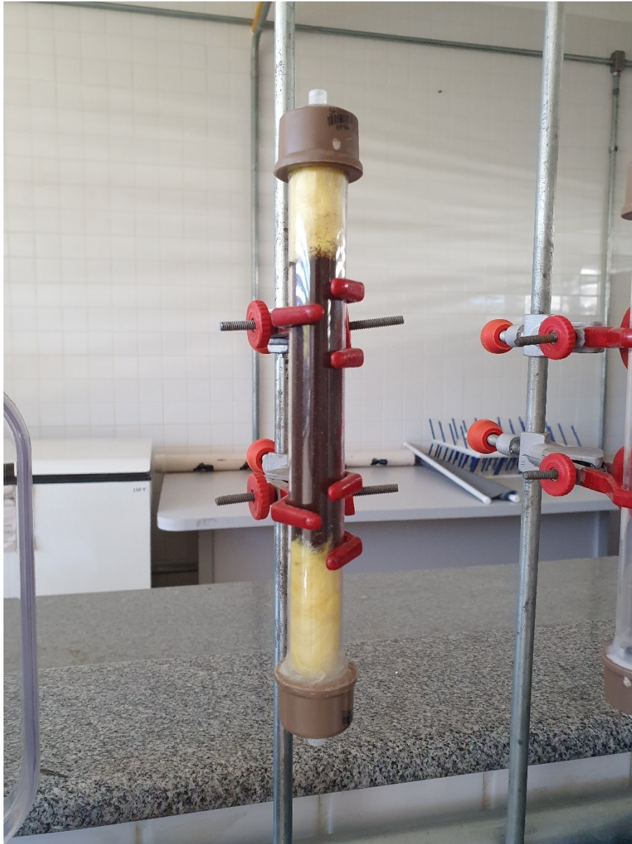
Figura 7 – Coluna de Leito Fixo montada para o Biossorvente
