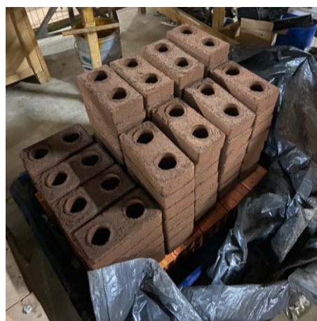
Figura 23 - Tijolos armazenados e agrupados por traço
