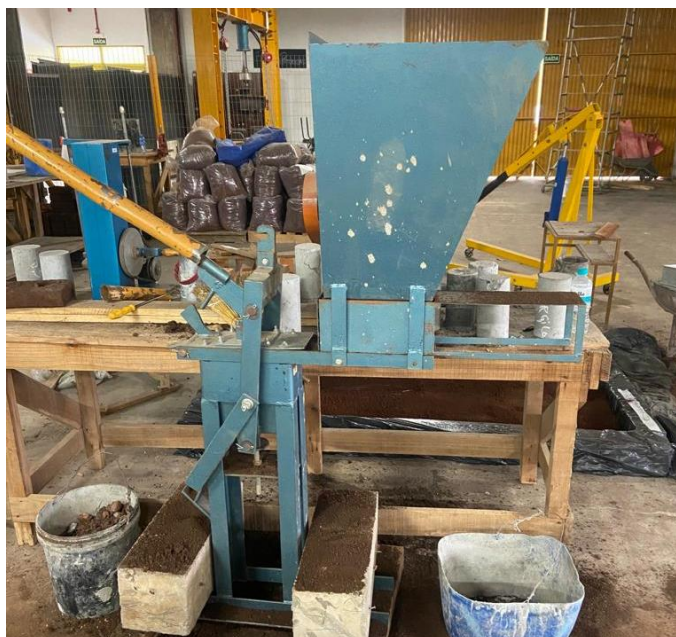
Figura 21 - prensa manual para fabricação de tijolos de solo-cimento
