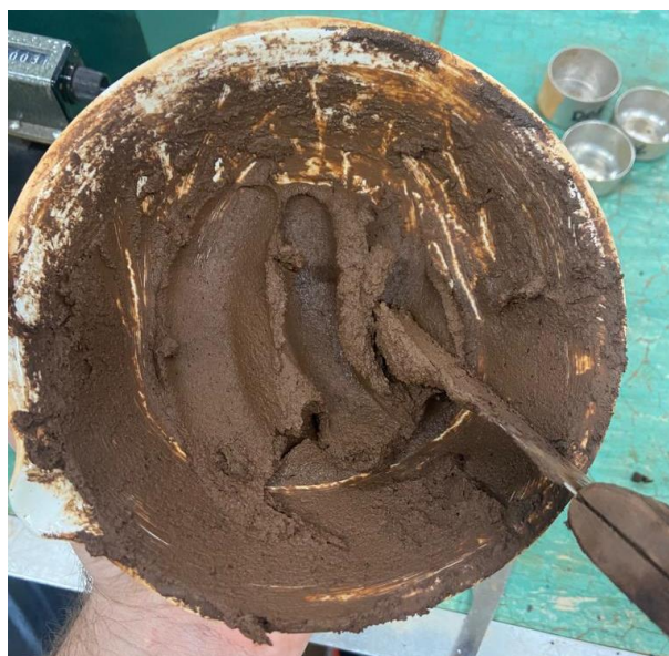
Figura 13 - amostra de solo sendo homogeneizada
