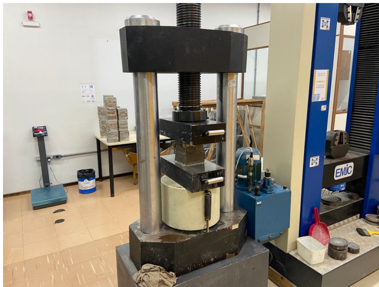
Figura 30 - Corpo de prova no ensaio de compressão
