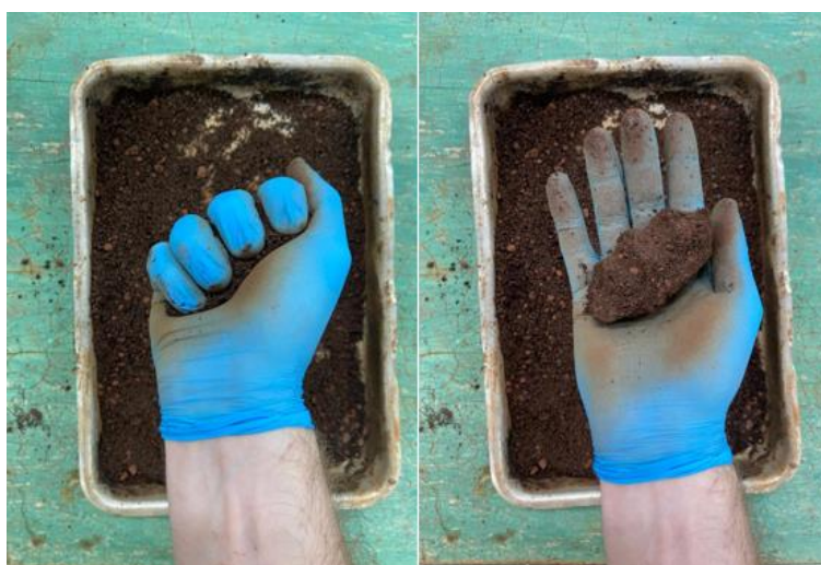
Figura 17 - Teste da Mão – moldagem do bolo
