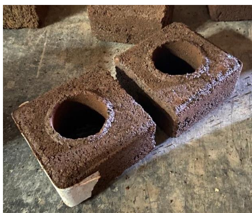
Figura 25 - Blocos de solo cimento cortados
