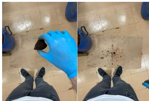
Figura 19 - Teste da Mão - queda e desagregação do bolo
