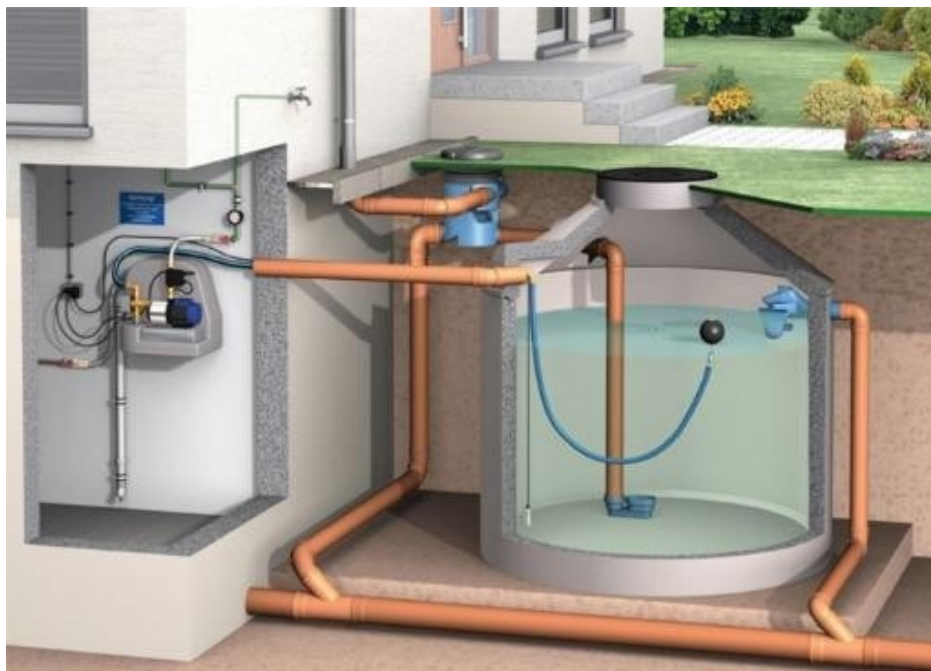
Figura 05- Modelo de uso de agua pluvial como torneira de jardim.
