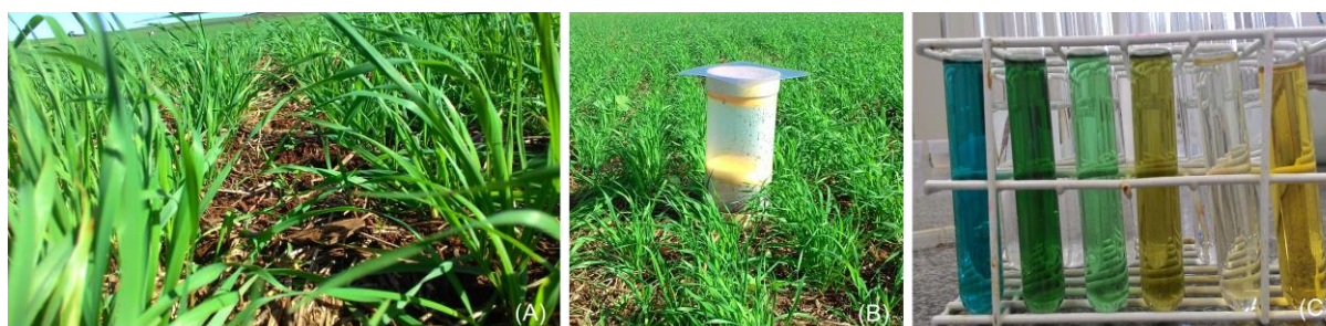
Figura 19. Coleta de amônia realizada pelo método de coletores semiabertos estáticos após aplicação de ureia na cultura da aveia preta comum. Abelardo Luz – SC. Maio de 2017. (A) Condição da pastagem no momento da aplicação de N (ureia); (B) Câmera coletora de amônia; (C) Análise em laboratório das perdas de N, quanto mais intensa a cor, maior a quantidade de N contido na amostra. UTFPR, Pato Branco - PR, 2018.
