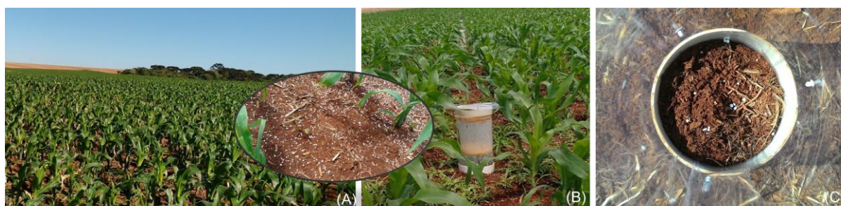
Figura 20. Coleta de amônia realizada pelo método de coletores semiabertos estáticos após a aplicação de ureia na cultura do Milho (AG 9025). Abelardo Luz – SC. Novembro de 2017. (A) Condição do experimento no momento da aplicação de N (ureia); (B) Câmera coletora de amônia; (C) Dose de ureia equivalente a dose de N aplicada em cada subparcela. UTFPR, Pato Branco - PR, 2018.
