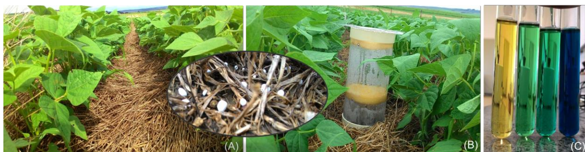
Figura 6. Coleta de amônia realizada pelo método de coletores semiabertos estáticos após a aplicação de ureia na cultura do Feijoeiro (IPR- Tuiuiu). Abelardo Luz – SC. Janeiro de 2017. (A) Condições do experimento no momento da aplicação de ureia (B) Câmera coletora de amônia; (C) Análise em laboratório. UTFPR, Pato Branco - PR, 2018.
