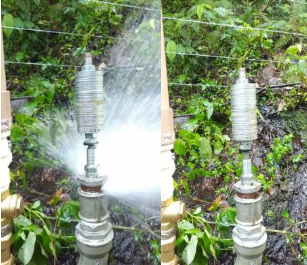
Figura 6 - Válvula de peso, iniciando e concluindo fechamento
