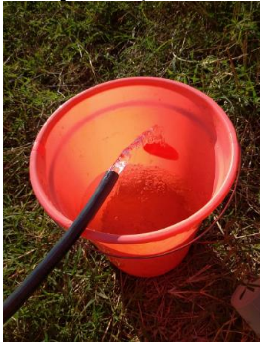
Figura 8 - medição de vazão
