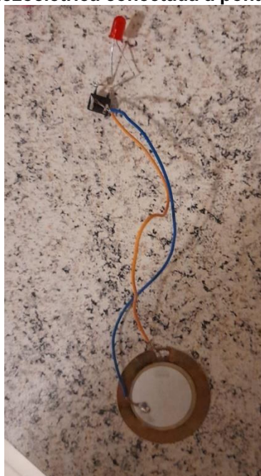
Figura 31 – Pastilha piezoelétrica conectada a ponte retificadora e ao LED
