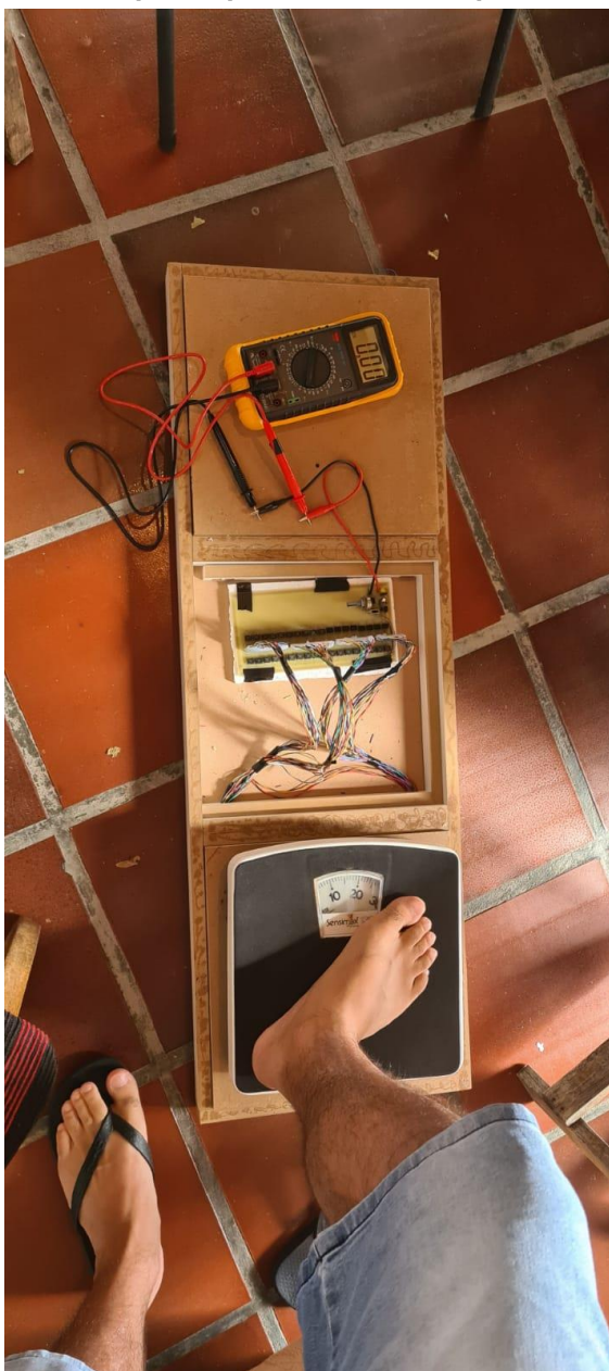
Figura 63 – Teste de peso aproximado de um passo de uma pessoa
