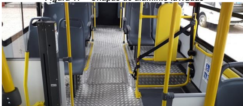
Figura 17 – Chapas de alumínio lavradas
