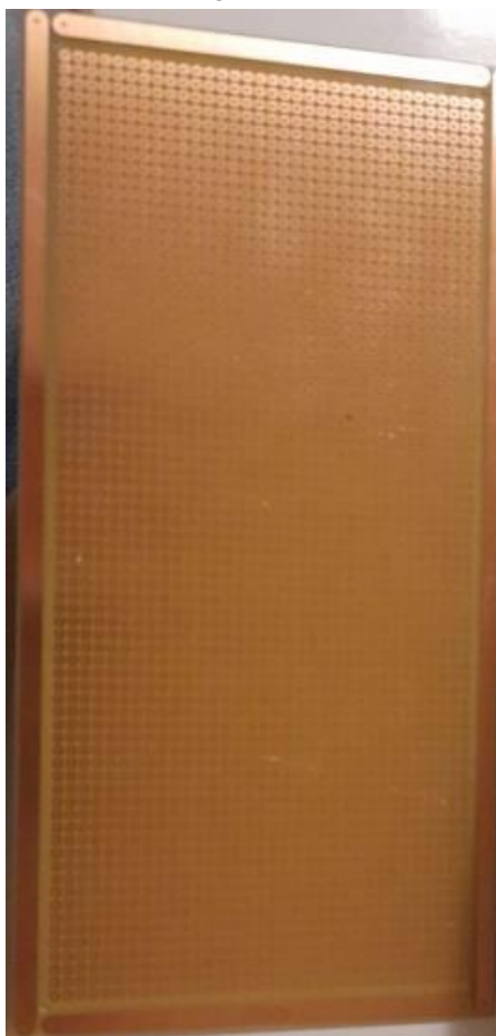
Figura 36 – Placa fenolite perfurada 10x20 cm PP-D(PD-9)
