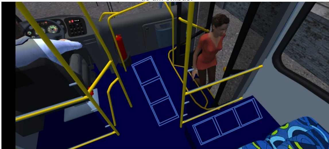
Figura 49 – Representação do dispositivo instalado na porta de entrada e no piso do assento de um ônibus.
