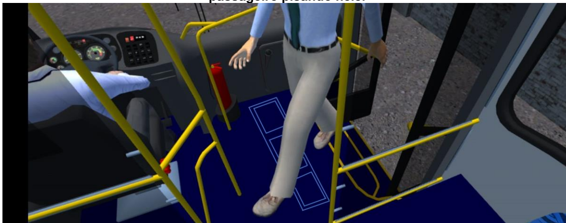
Figura 50 – Representação do dispositivo instalado na porta de entrada de um ônibus com um passageiro pisando nele.
