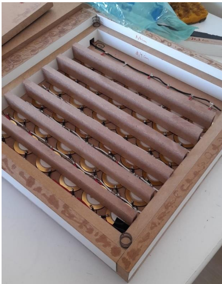
Figura 53 – Alinhamento das peças de impacto nos cristais piezoelétricos
