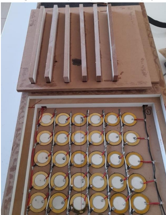
Figura 54 – Colagem da tampa de pisar com as peças de impacto
