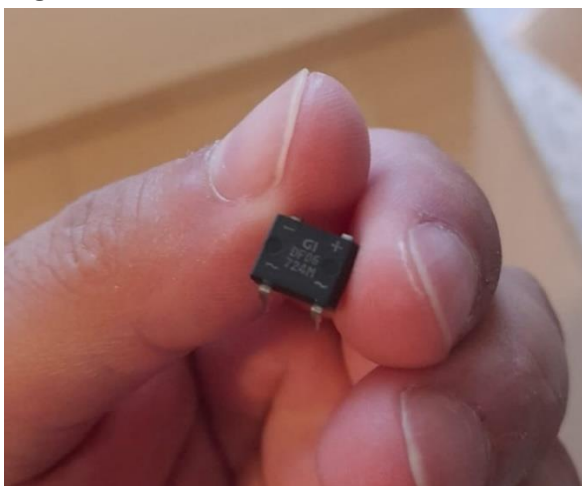
Figura 28 – Ponte retificadora DF06 1A x 600V
