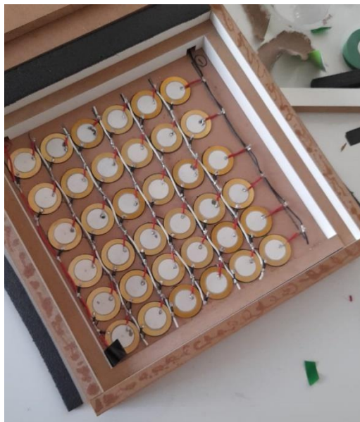
Figura 52 – Instalação dos cristais piezoelétricos na parte estrutural
