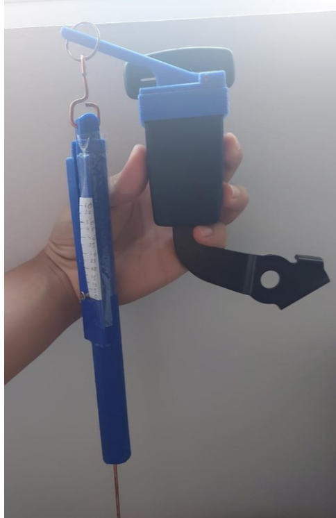
Figura 51 - Dispositivo para medição da força de desacoplamento
