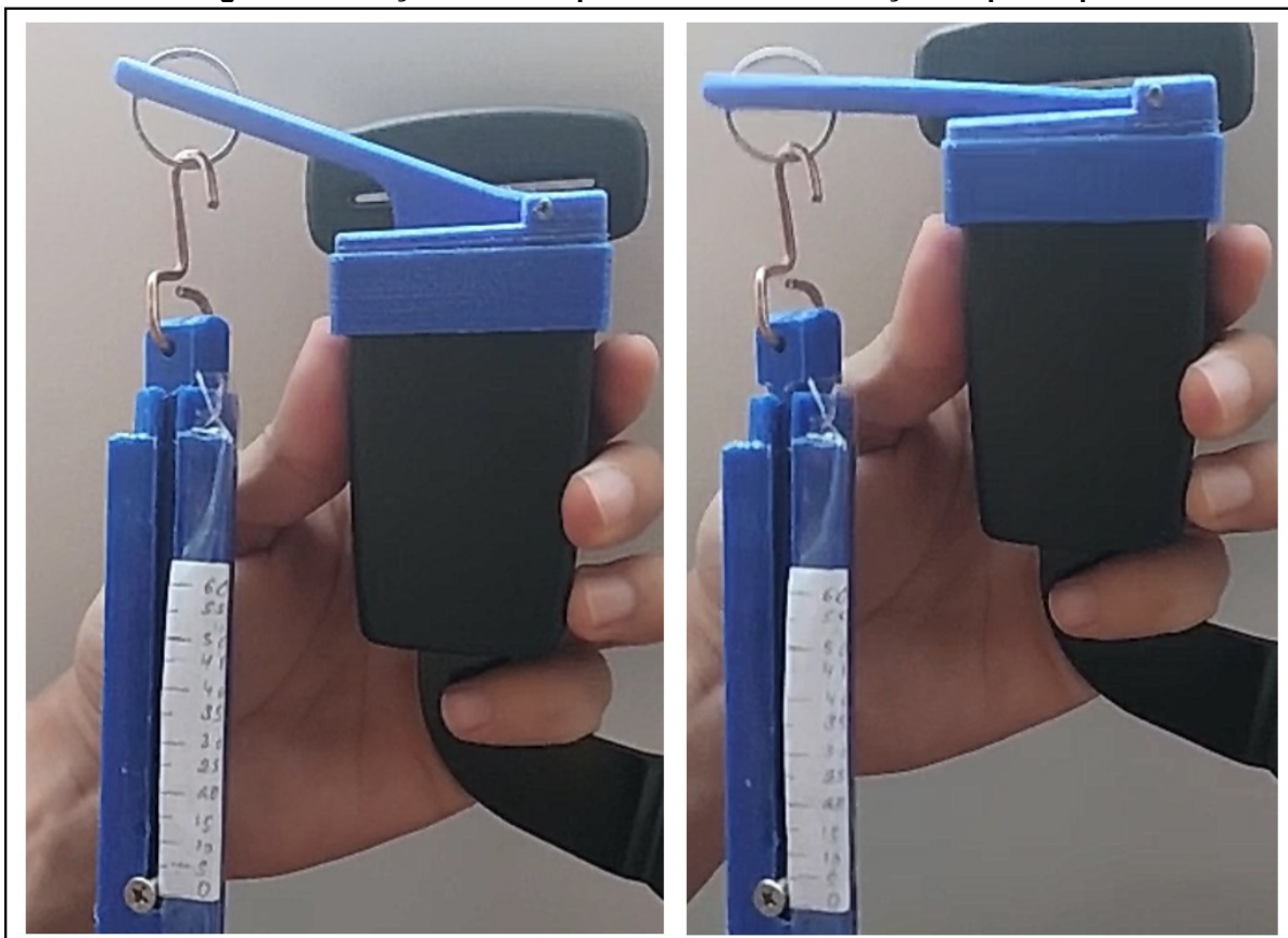
Figura 53 - Força de desacoplamento com a utilização do protótipo
