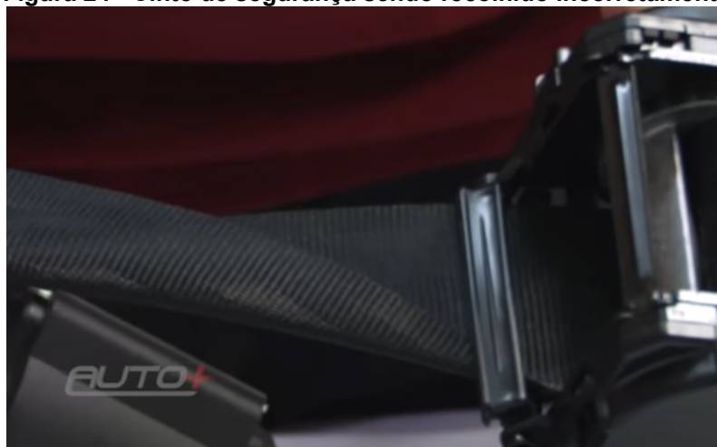
Figura 24 - Cinto de segurança sendo recolhido incorretamente
