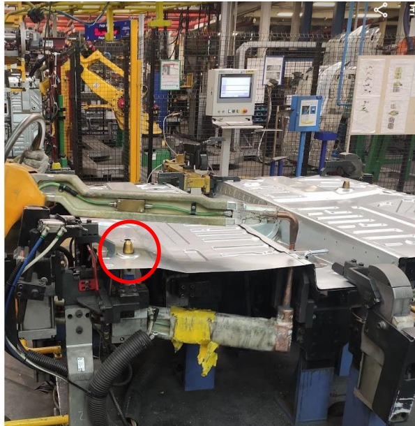
Figura 18 - Travamento peça dispositivo
