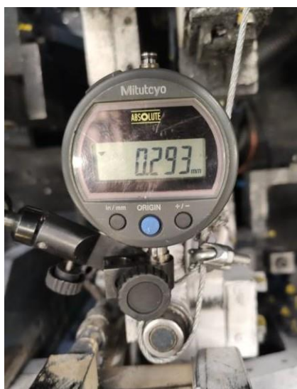
Figura 30 - Evidência deformação piloto
