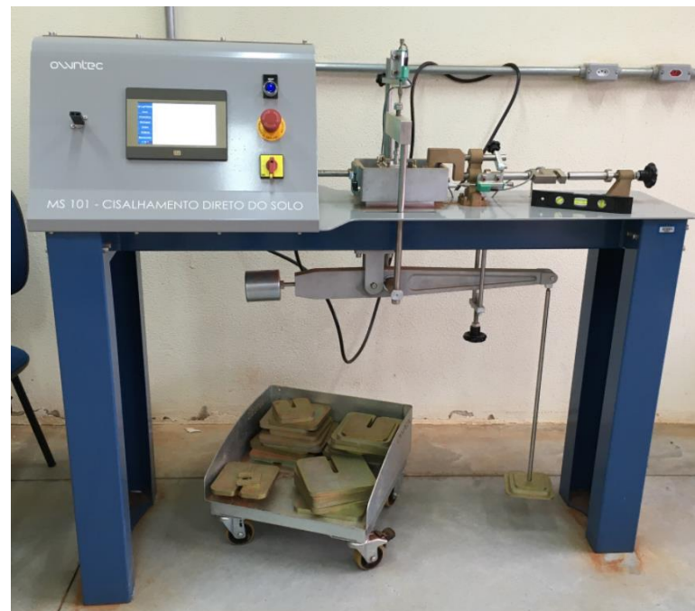
Figura 27 - Aparelho de cisalhamento direto do solo
