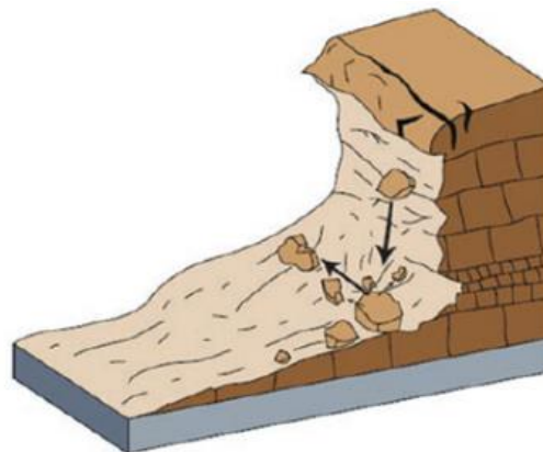
Figura 8 – Ruptura por queda
