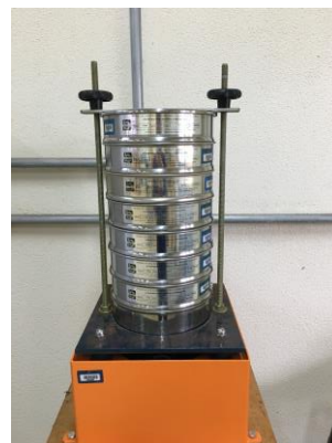
Figura 22 – Análise granulométrica conjunta (a) ensaio de sedimentação e (b) ensaio de peneiramento fino
