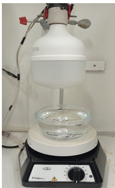
Figura 13. Reator fotoquímico utilizado nas degradações com lâmpada visível (LED)
