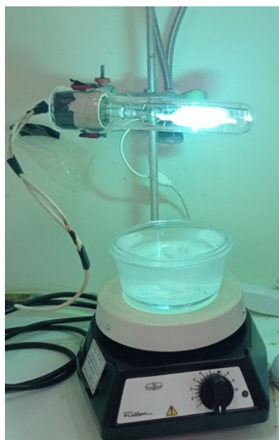
Figura 11 - Reator fotoquímico utilizado nas degradações com lâmpada UVA-Vis (suspensa)
