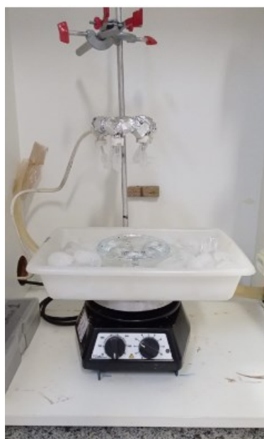
Figura 12 - Reator fotoquímico utilizado nas degradações com lâmpada visível (halógena)
