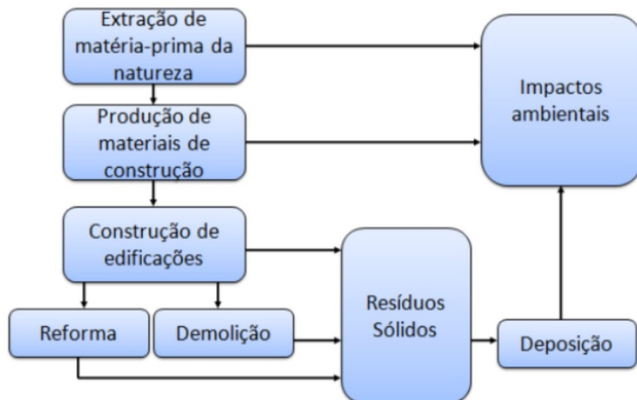
Figura 1 - Cadeia resumida da construção civil
