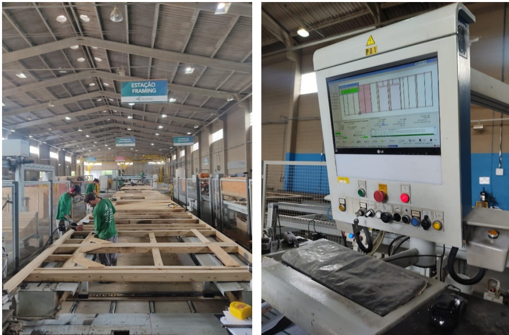
Figura 22 – Linha de produção automatizada de paredes (Linha Weinmann)
