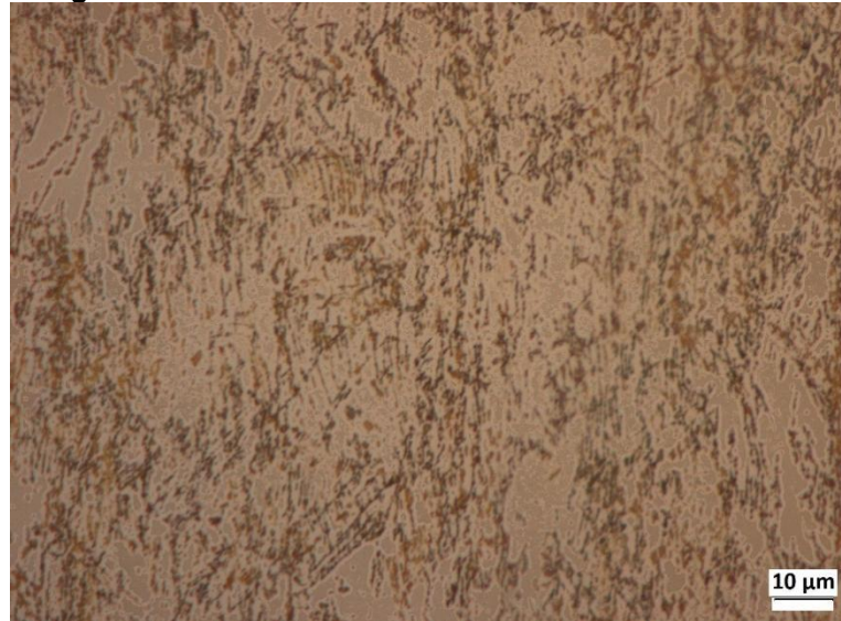
Figura 24 - Microestrutura do latão C230 na amostra3.
