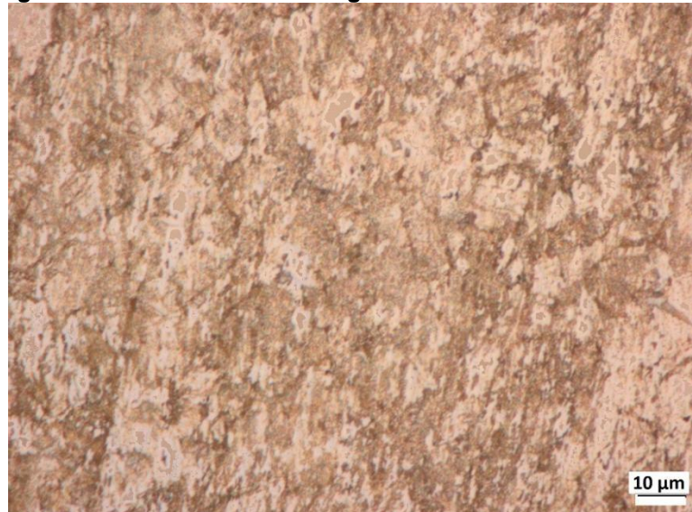
Figura 23 - Microestrutura da liga de latão C230 na amostra 2.
