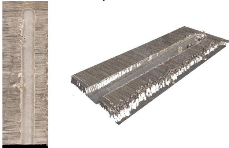
Figura 32 – Micro canais na amostra 3 com profundidade de corte de 0,05mm e avanço de 10 \mu\text{m}/\text{dente} .
