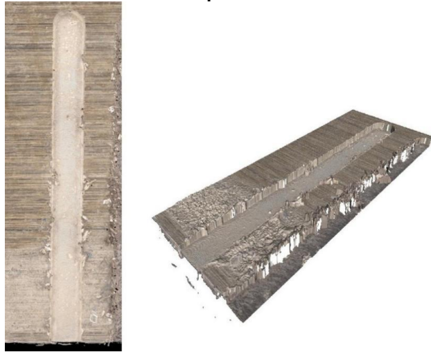
Figura 31 – Micro canais na amostra 2 com profundidade de corte de 0,05mm e avanço de 10 \mu\text{m}/\text{dente} .
