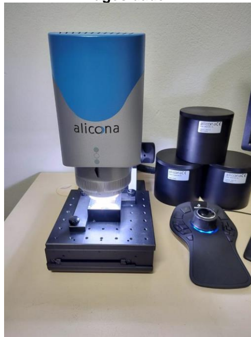
Figura 21 - Microscópio Alicona Infinit Focus utilizado para as análises de rebarbas e rugosidade.
