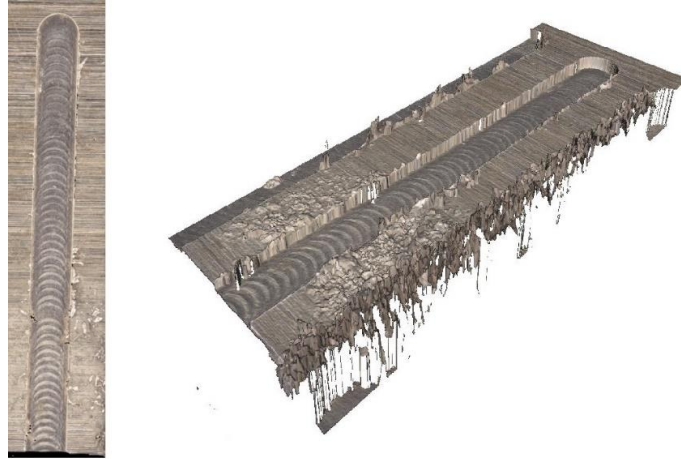
Figura 29 – Micro canal na amostra 2 com ap 0,05 mm e fz de 3 \mu m/dente
