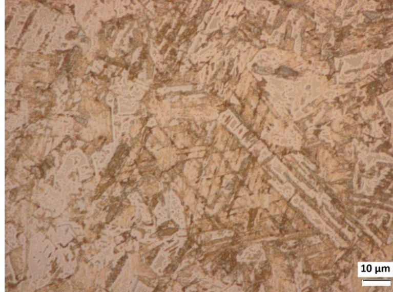
Figura 22 – Microestrutura da liga de latão C230 na amostra 1.
