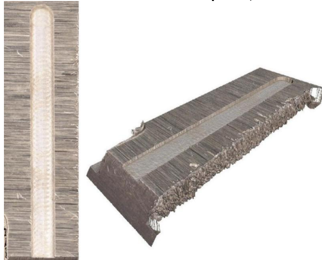
Figura 28 – Micro canal na amostra 1 com ap de 0,05 mm e fz de 3 \mu\text{m}/\text{dente}
