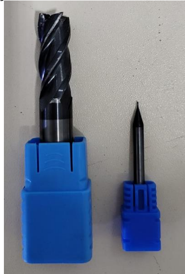
Figura 20 – Comparação entre uma fresa convencional e uma microfresa.
