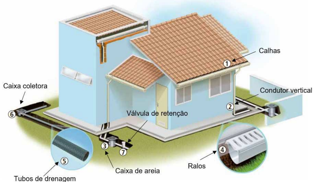
Figura 17 — Componentes das instalações prediais de águas pluviais.
