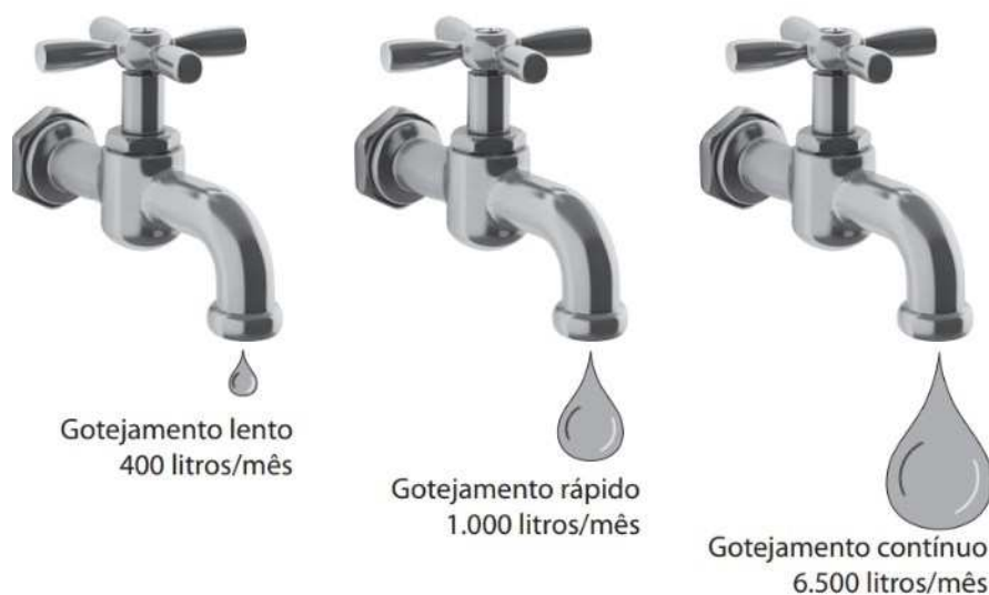
Figura 6 — Desperdício de água em torneiras.
