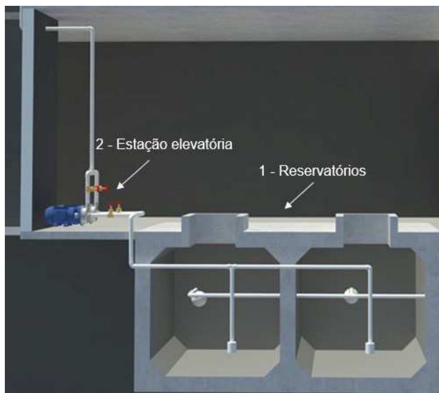
Figura 2 — Subsistema predial de reservação.
