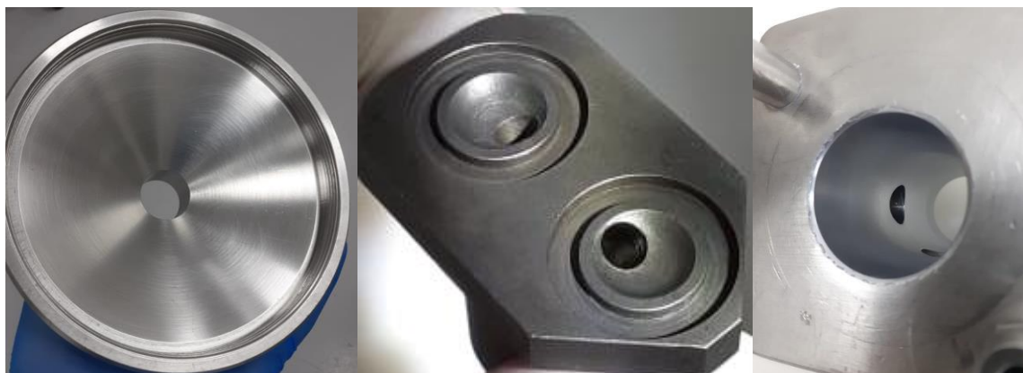
Figura 10 - Bloco de distribuição, bico e base do reservatório limpos (1º lote).
