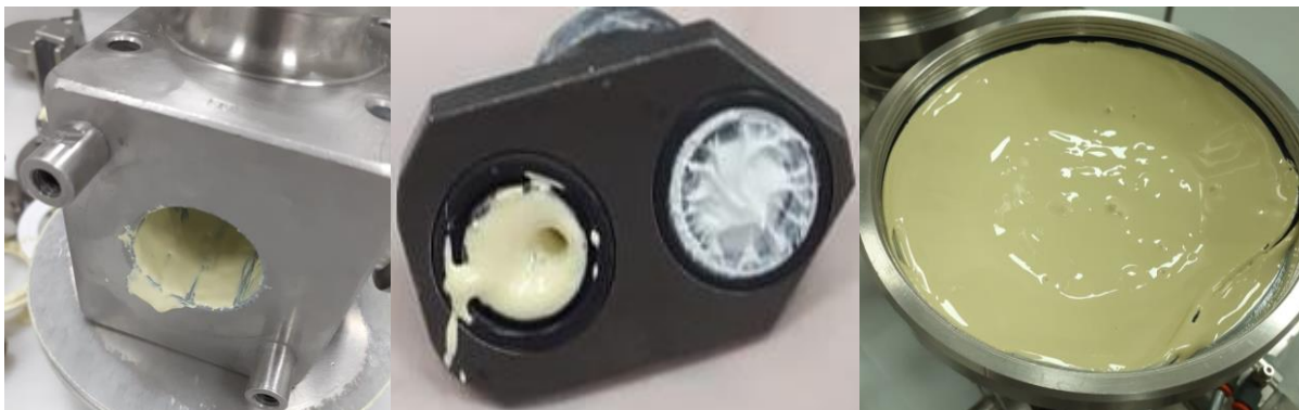
Figura 9 - Bloco de distribuição, bico e base do reservatório da envasadora OMAS.
