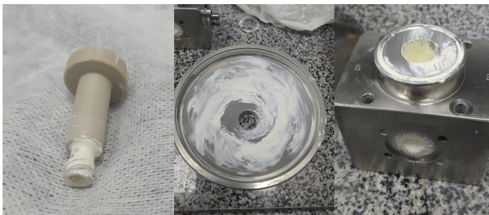
Figura 14 - Bico, base do reservatório e bloco de distribuição da envasadora OMAS sujo.
