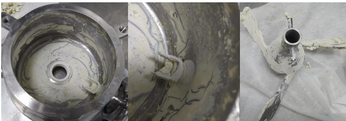
Figura 26 - Vaso, chopper e impelidor do misturador de alto cisalhamento sujo.
