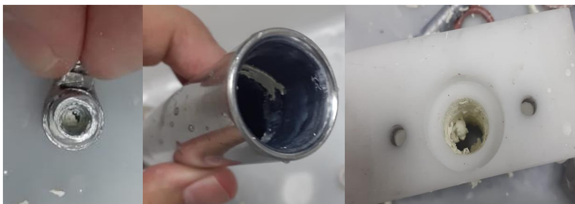
Figura 19 - Bico, reservatório e bloco de distribuição da envasadora de seringas sujo.
