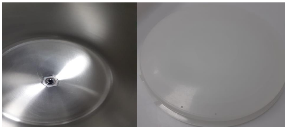
Figura 32 - Reservatório e tampa da envasadora de líquidos limpos (2º lote).
