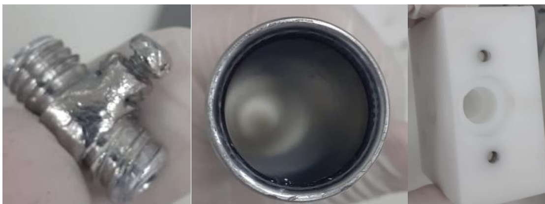
Figura 21 - Bico, reservatório e bloco de distribuição limpos (2ª campanha).
