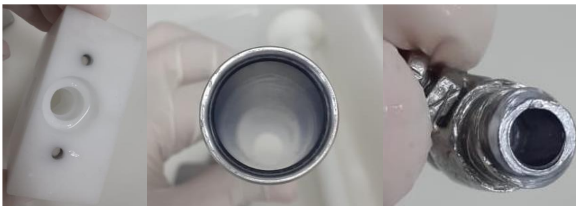
Figura 20 - Bloco, reservatório e bico limpos (1ª campanha).
