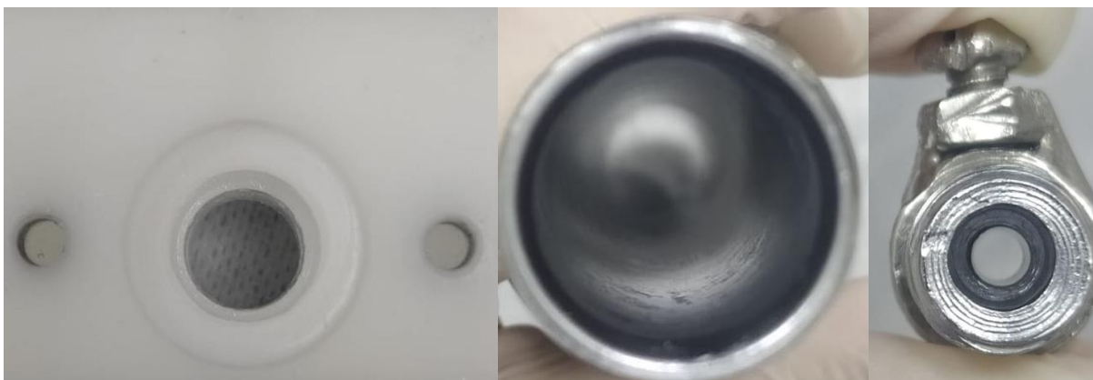
Figura 22 - Bloco de distribuição, reservatório e bico limpos (3º campanha).
