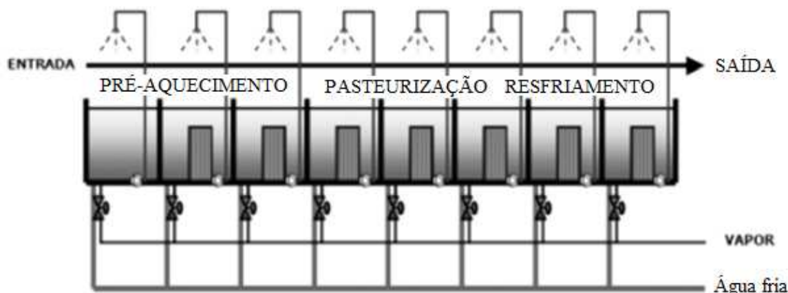
Figura 4: Esquema de pasteurizador tipo túnel.
