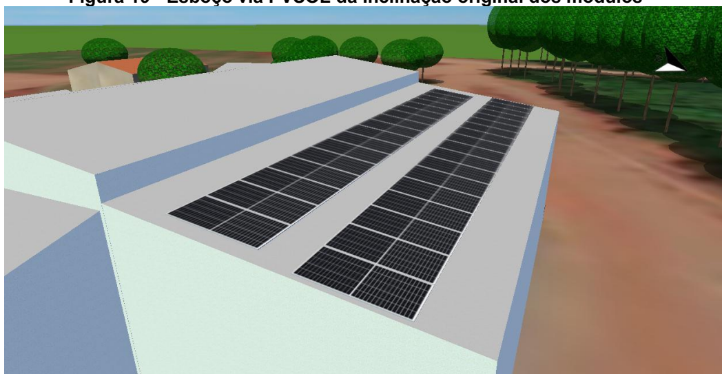
Figura 19 - Esboço via PVSOL da Inclinação original dos módulos
