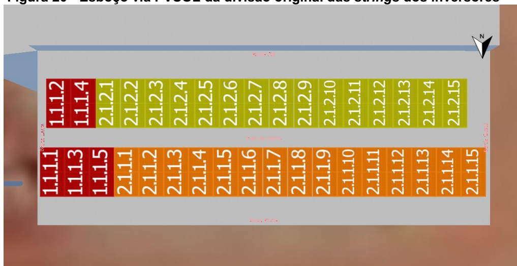
Figura 20 - Esboço via PVSOL da divisão original das strings dos inversores
