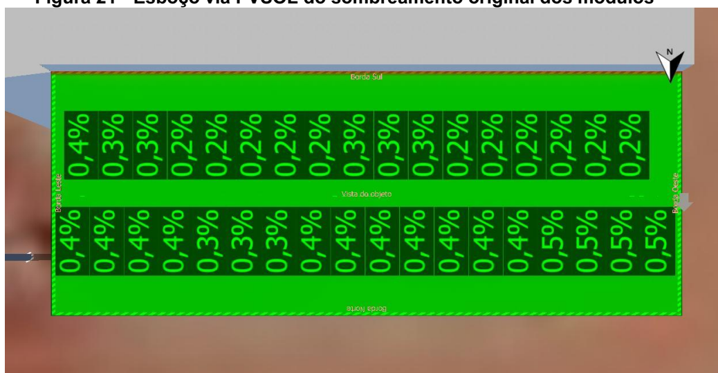
Figura 21 - Esboço via PVSOL do sombreamento original dos módulos
