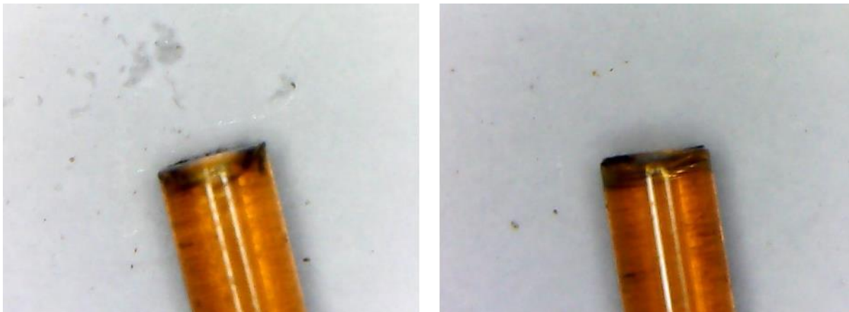
Figura 23 - Pontas da fibra óptica depois da clivagem.
