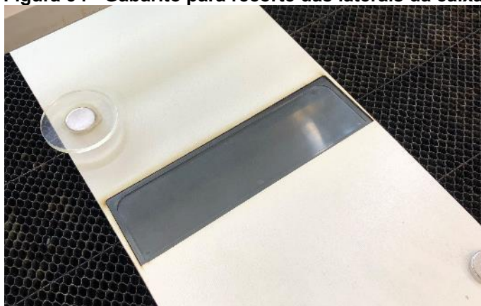
Figura 34 - Gabarito para recorte das laterais da caixa.
