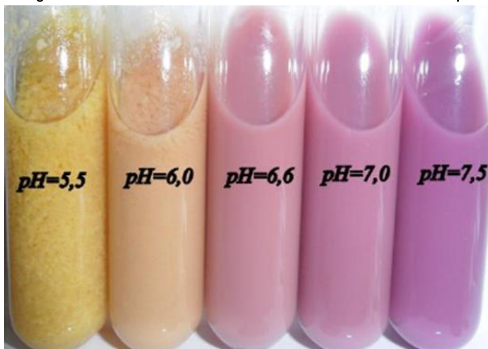
Figura 1 - Teste de Alizarol em leite bovino com diferentes valores de pH
