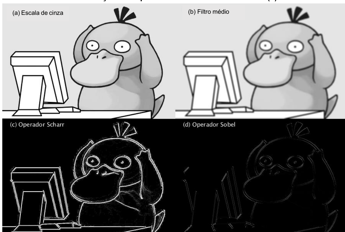
Figura 12 - Aplicação da operação convolução. Imagem monocromática (a). Resultado da aplicação da convolução com filtro médio com tamanho 9x9 (b). Resultado da aplicação da convolução com operador Scharr horizontal e vertical (c). Resultado da aplicação da convolução com operador Sobel horizontal e vertical (d)
