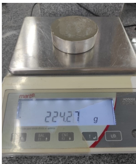
Figura 10 – Amostra para o ensaio de densidade de massa e teor de ar incorporado.
