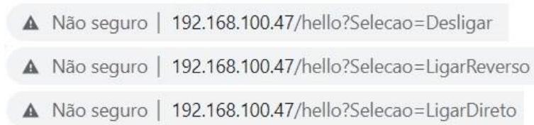
Figura 12 – URL's dos comandos enviados para o inversor de frequência
