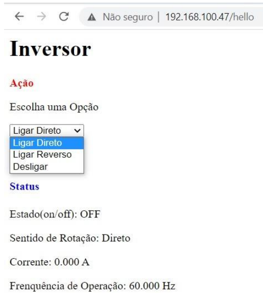
Figura 11 – Página Web com as três opções de ação para comando
