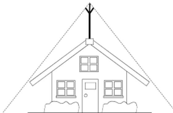
Figura 5 - Método do ângulo de proteção
