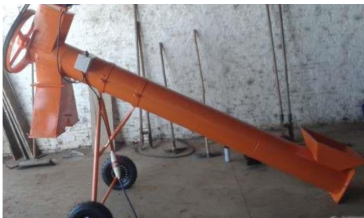
Fotografia 1 - Caracol do tipo helicoidal
