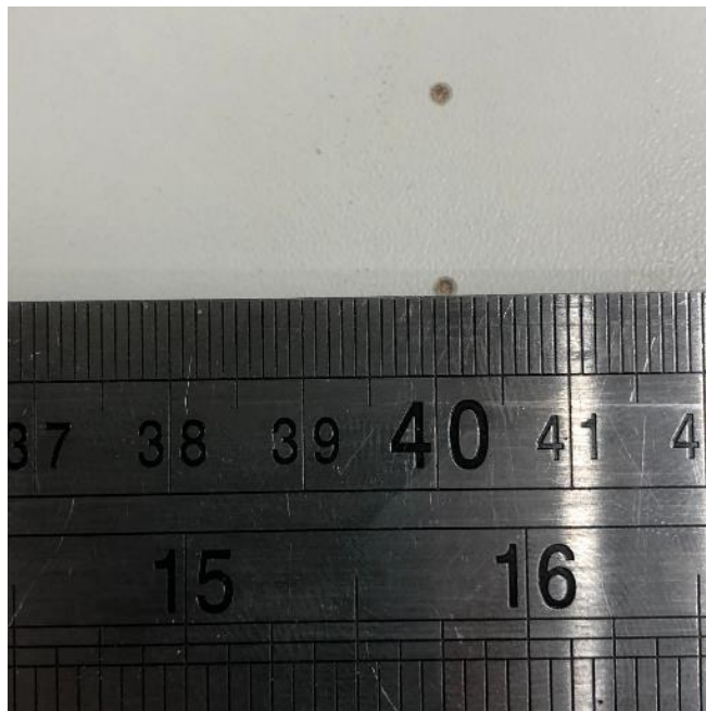
Figura 35 - Teste de calibração e repetibilidade do eixo y
