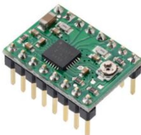
Figura 21 - Driver a4988 utilizado para acionamento dos motores
