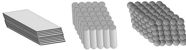
Figura 19 – Representação de estrutura periódica de uma, duas e três dimensões
