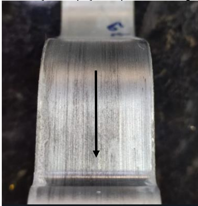
Figura 16 – Direção de captação dos parâmetros de rugosidade
