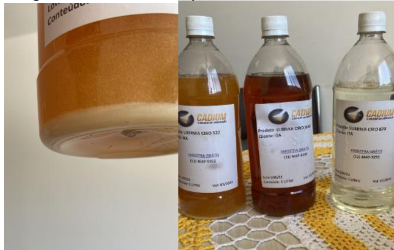
Figura 19 – Acúmulo de depósitos nos lubrificantes
