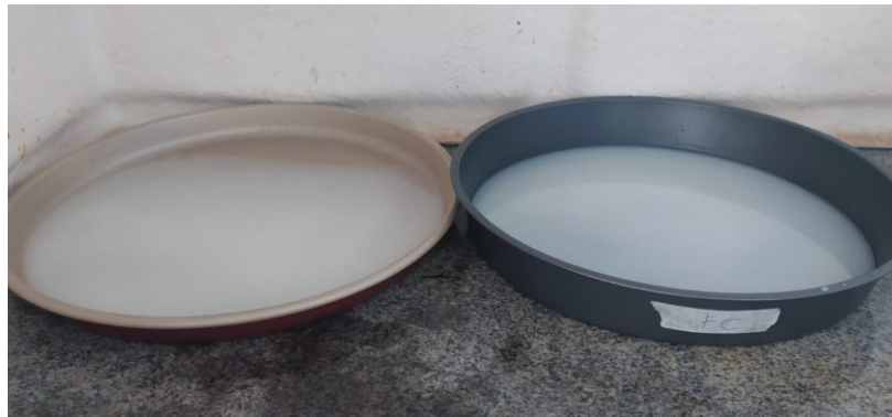
Figura 2 - Fotografia das soluções filmogênicas depositadas em formas de Teflon
