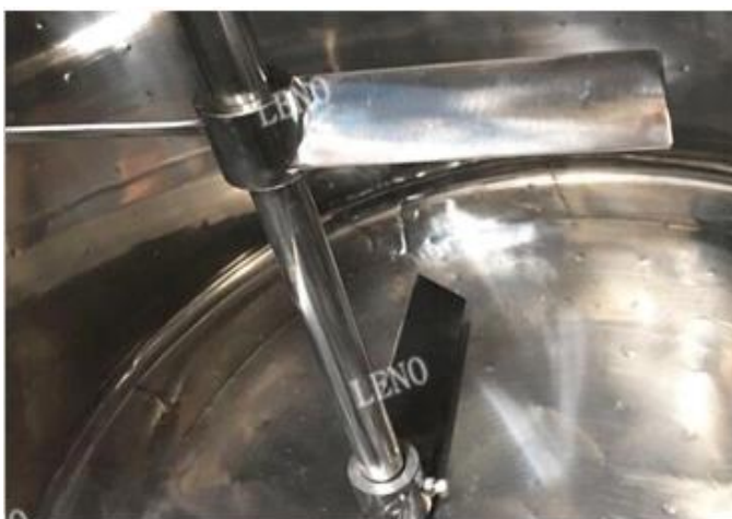
Figura 31 - Ilustração do agitador pás restas inclinadas.
