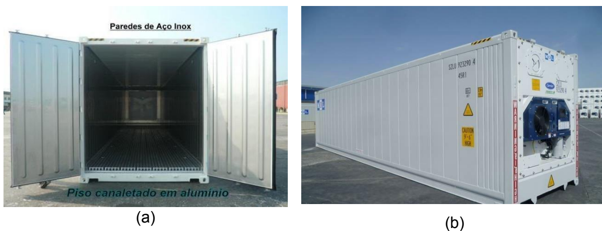
Figura 49 - Imagem ilustrativa do container refrigerado. (a) Características internas; (b) Características externas.
