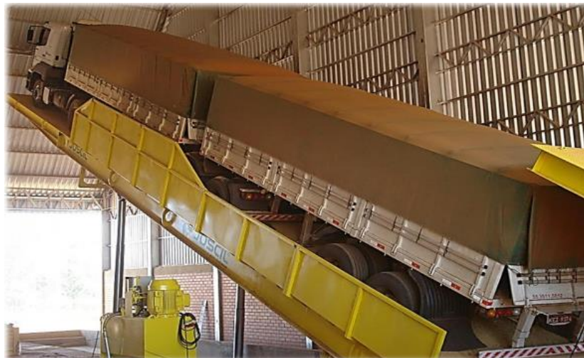
Figura 15 - Rampa de descarregamento.
