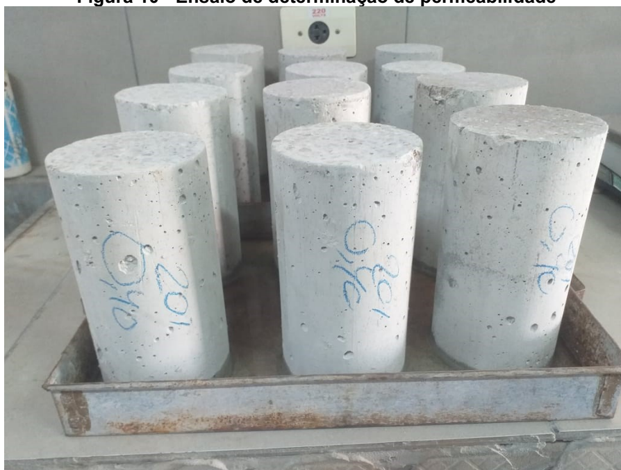
Figura 10 - Ensaio de determinação de permeabilidade
