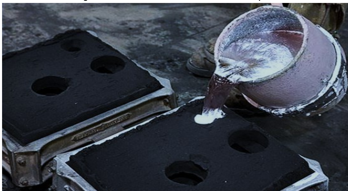
Figura 3 - Preenchimento do molde com metal líquido
