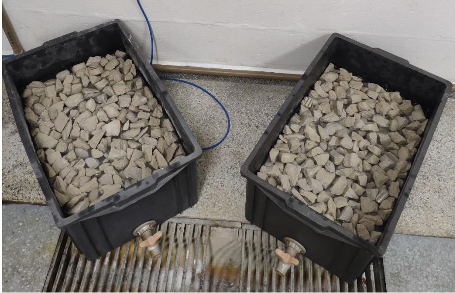
Figura 15 - Imagem dos fragmentos do CA imersos em cimento branco (pré-tratamento)
