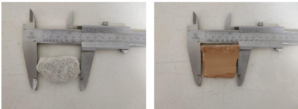
Figura 17 – Medição dos fragmentos utilizados no sistema Wetlands
