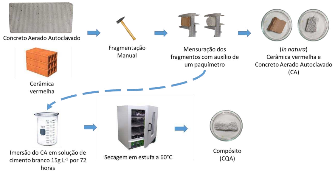
Figura 14 - Esquema das etapas de preparação dos materiais
