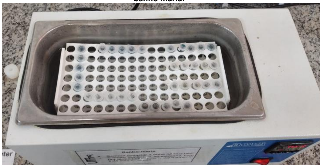
Figura 4. Etapa do procediemtno RP-DLLME com graxa de lítio sob aquecimento em banho maria.
