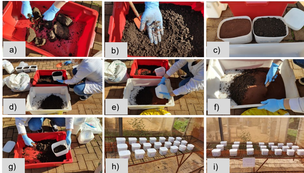
Figura 5: Montagem das associações de LE, solo agrícola e in natura para processo de biorremediação
