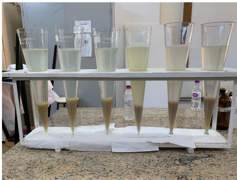
Figura 7 – Cone imhoff utilizado para medir a geração de lodo.
