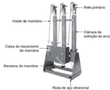
Figura 6 – Disjuntor a pequeno volume de óleo.
