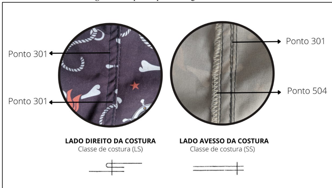
Figura 9 – Tipos de pontos no gancho do shorts.
