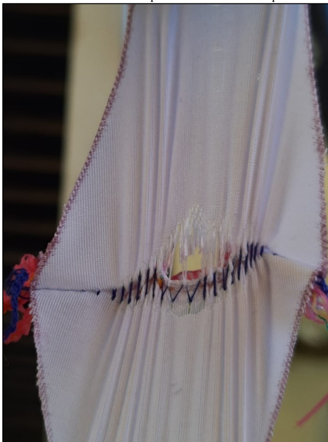
Figura 20 - Rompimento de costura no sentido paralelo a trama com o ponto 516 (máquina interlock).
