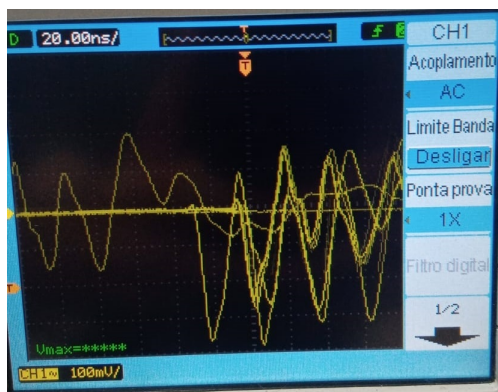
Figura 38 – Transiente proveniente da fonte chaveada de 24 V.
