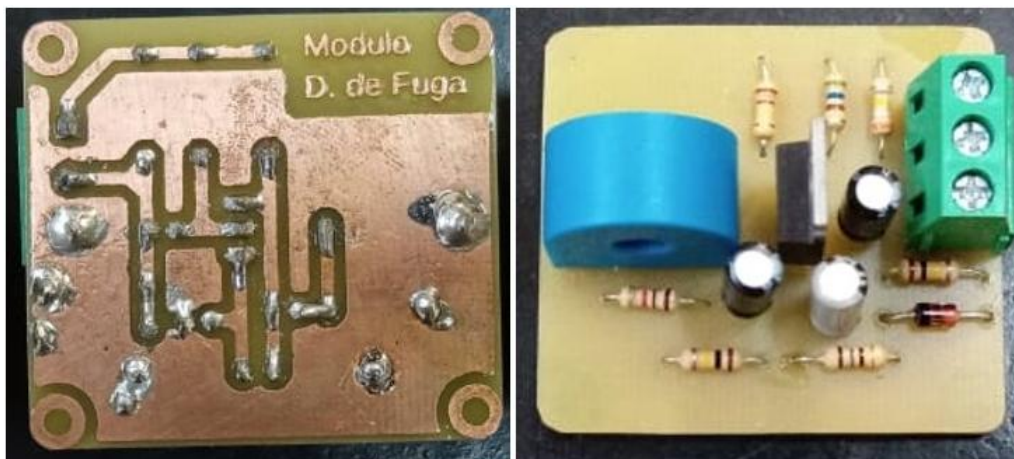
Figura 36 – Placas para monitoramento dos circuitos elétricos.
