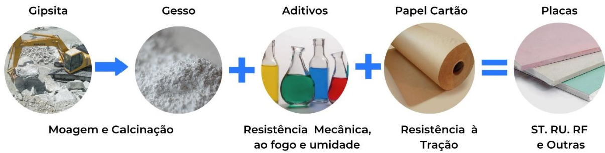
Figura 4 - Processo simplificado da fabricação da placa de gesso acartonado
