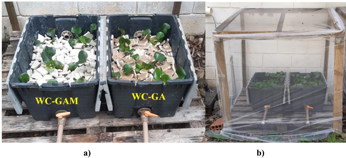
Figura 13 - Instalações dos WCFV: a) sistemas WC-GAM e WC-GA e b) proteção dos sistemas contra intempéries climáticas
