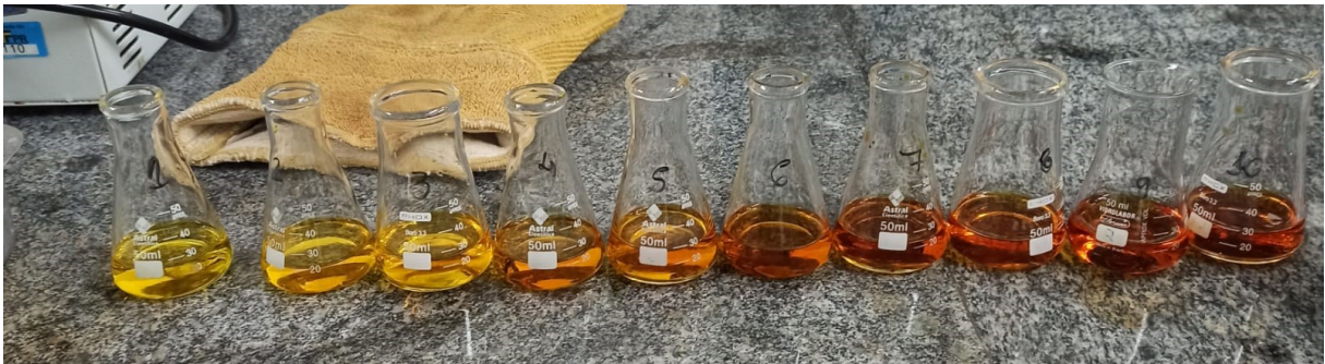
Figura 6 – Reação entre o açúcar redutor e o ácido 3,5-dinitrosalicílico (cor amarelo)
