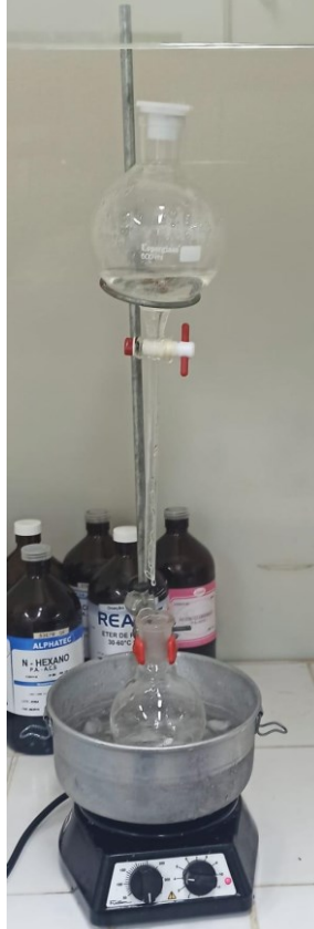
Figura 8 – Síntese do hidrogenossulfato de trietilamônio
