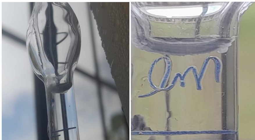
Figura 3: Óleo essencial extraído no aparato Clevenger
