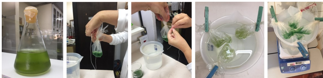
Figura 28 - Processo de extração de enzimas através de dialise
