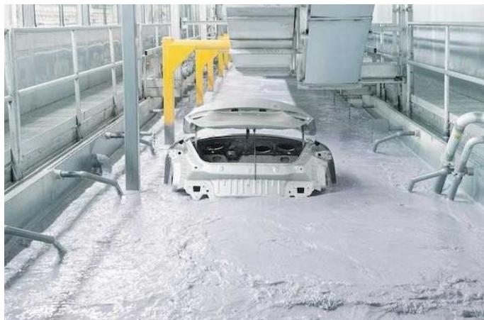
Figura 4 - Processo real de aplicação de e-coating.
