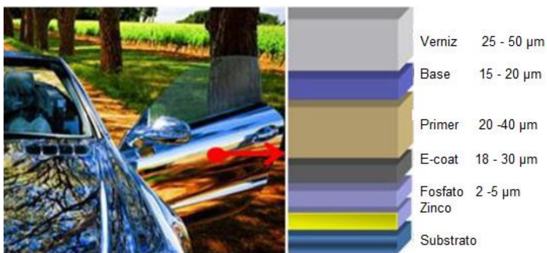
Figura 1 - As camadas de pintura: do substrato ao verniz.
