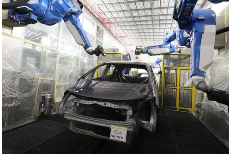
Figura 5 – Aplicação de primer robotizada.
