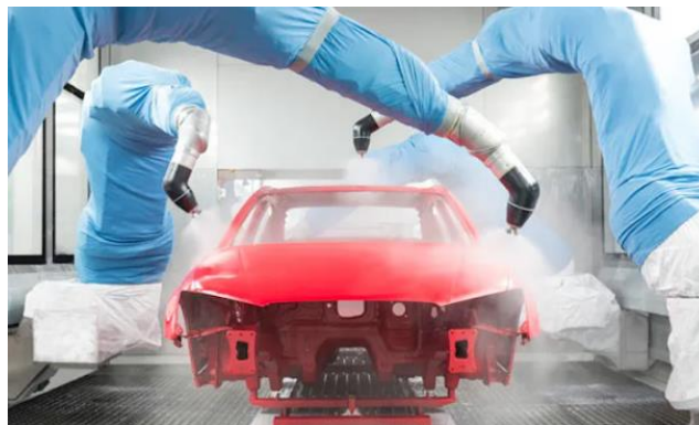
Figura 6 - Processo de pintura automático.
